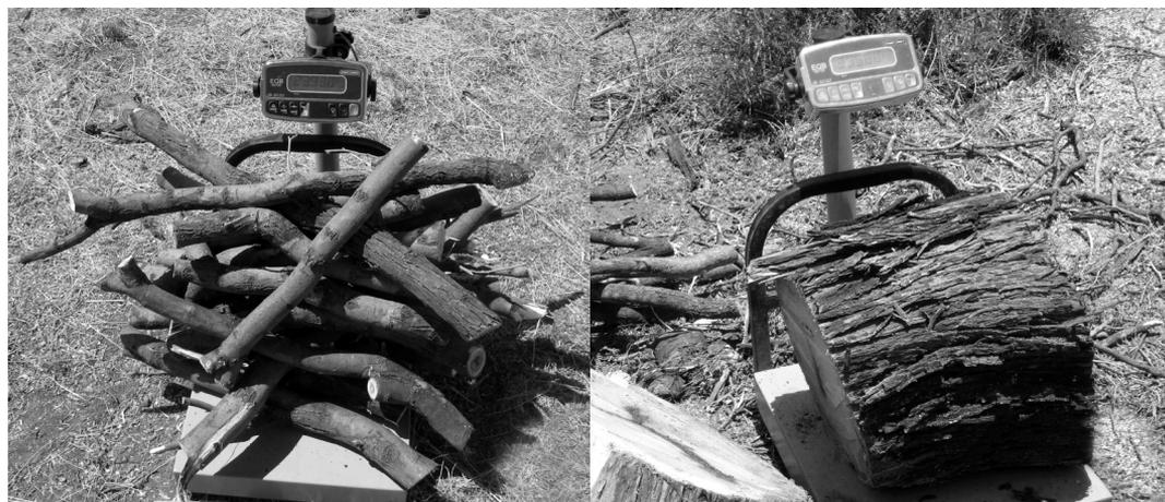
Figura 5.11. Báscula industrial, usada en el pesaje de las mediciones de biomasa.
