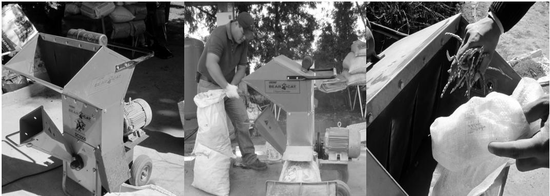
Figura 4.14. Método de extracción de semilla con chiper eléctrico.
