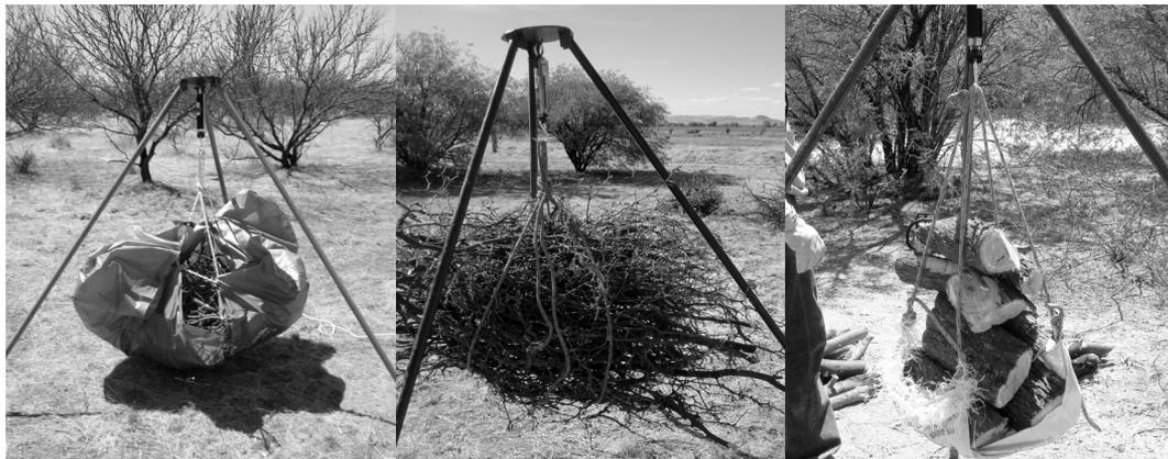
Figura 5.10. Báscula mecanizada, usada en el pesaje de las mediciones de biomasa.
