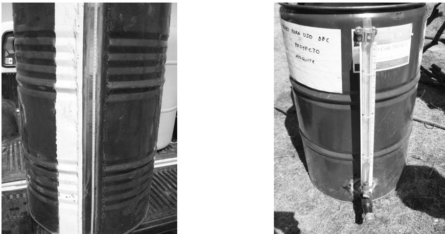
Figura 5.6. Tipos de xilómetros diseñados para el cálculo de volumen comercial en mezquite (*Prosopis laevigata*).
