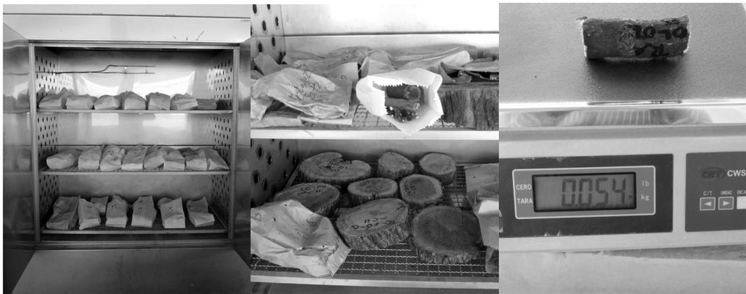
Figura 5.9. Secado de las muestras de cada componente.
