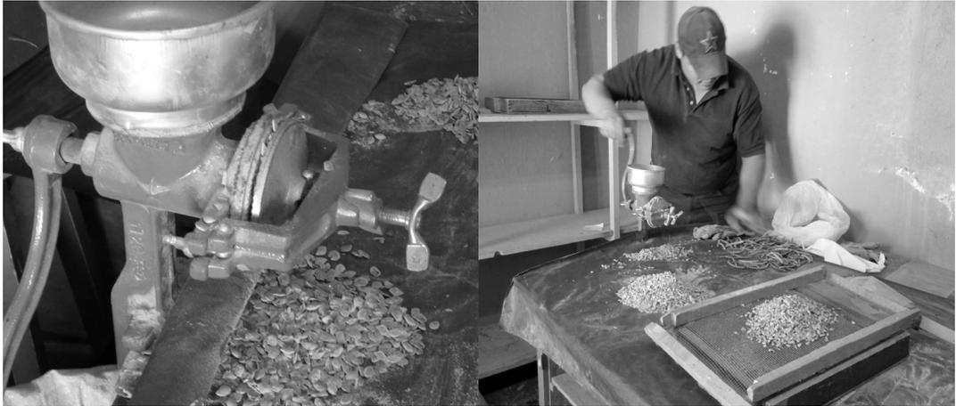
Figura 4.13. Método de extracción de semilla con molino manual.
