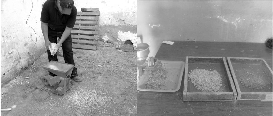
Figura 4.15. Ventilador eléctrico y mallas para quitar impurezas.
