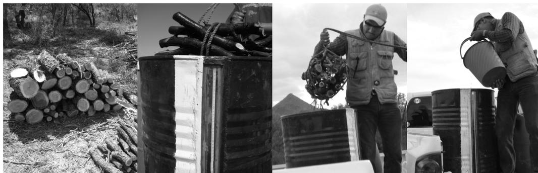
Figura 5.7. Proceso de uso del xilómetro para determinar volumen comercial.
