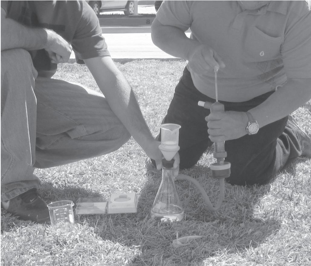
Figura 4.4. Equipo utilizado para filtrar el agua en campo, eliminar sólidos en suspensión y evitar riesgos de contaminación biológica.
