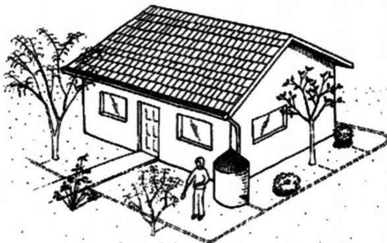
Figura 8.10: Almacenamiento superficial en tanques del agua colectada
