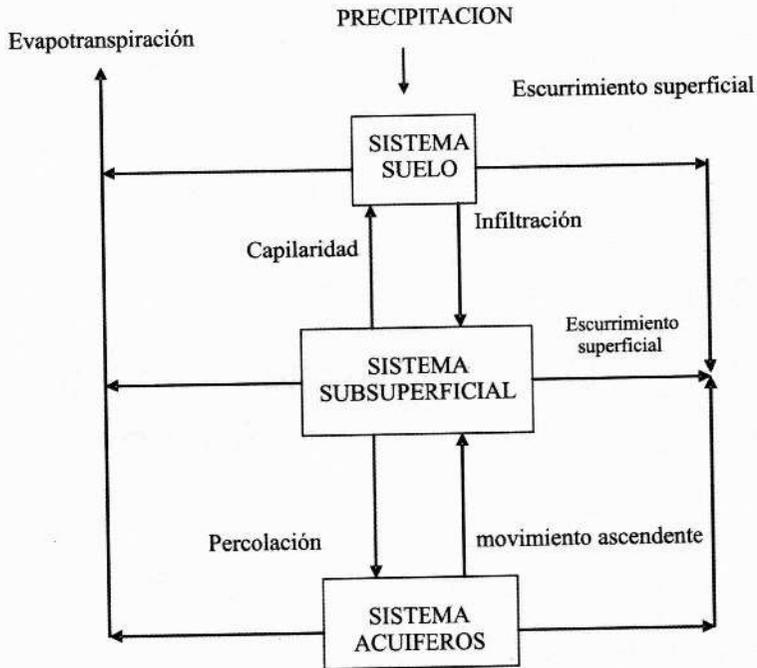
**Figura 1: Movimiento de humedad en el sistema suelo**
