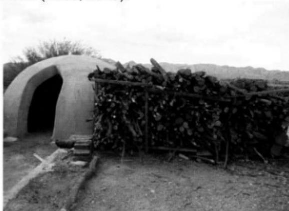
**Figura 6. Horno de ladrillo para el proceso de carbonización de mezquite, éste incrementa la eficiencia de producción de carbón de un 30 a un 33%.**
