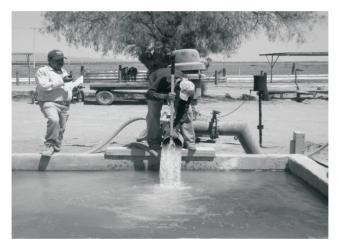
Figura 30. Determinación del gasto por la técnica del molinete.
