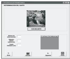
Figura 13. Ventana para determinar el gasto por la técnica del molinete (tubo parcialmente lleno).
