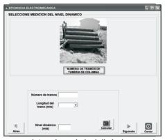
Figura 17. Ventana para determinar el nivel dinámico por el método de número de tramos.
