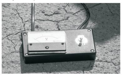
Figura 33. Dispositivo para realizar sondeo a los pozos.
