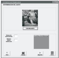
Figura 12. Ventana para determinar el gasto por la técnica del molinete (opción tubo lleno).
