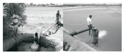
Figura 29. Determinación del gasto con la técnica del método volumétrico.
