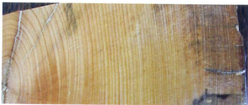
Figura 6. Sección transversal de Pinus cembroides . La nitidez de los anillos anuales es mejor y la especie muestra una menor proporción de microanillos y de anillos perdidos en comparación con Pinus pinceana .
