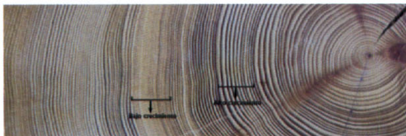
Figura 2. Sección transversal, donde se observa alta variabilidad en los crecimientos anuales (anillos anchos y estrechos), situación que se atribuye a una alta sensibilidad climática.
