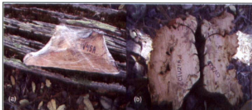
**Figura 12.** Protección de las muestras para evitar su deterioro durante el transporte (a) y muestras seccionadas con señalamientos de la dirección de las piezas para facilitar su integración en el laboratorio (b).
