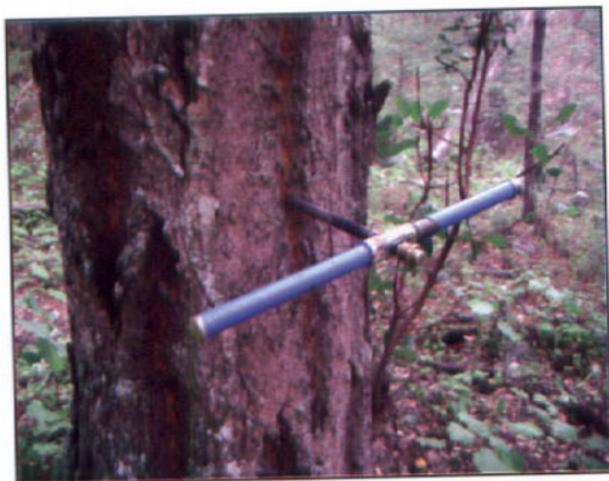
Figura 11. Toma de muestra de *Pseudotsuga menziesii* (Mirb.) empleando taladro de Pressler con fines paleoclimáticos.
