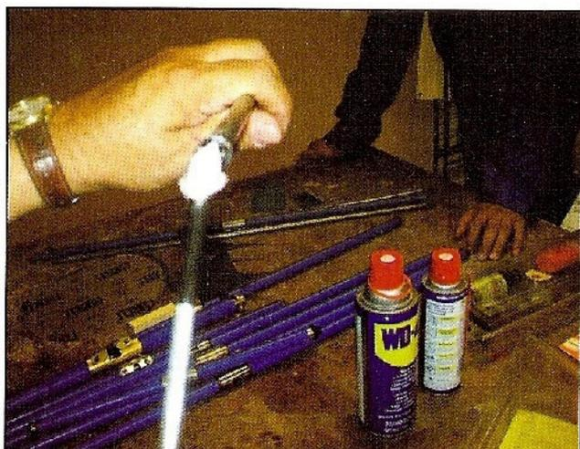
**Figura 16.** La limpieza de taladros es de gran importancia después de una jornada de trabajo, esto prolonga la vida útil del equipo al evitar corrosión de la barrena y del extractor, y permite obtener muestras más limpias y de mejor calidad.
