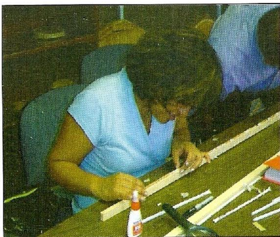
**Figura 17.** El montaje correcto de los núcleos de crecimiento es importante para distinguir con claridad los límites entre bandas de crecimiento. Para el caso de coníferas la muestra debe montarse de tal manera que las traqueidas queden en posición vertical.
