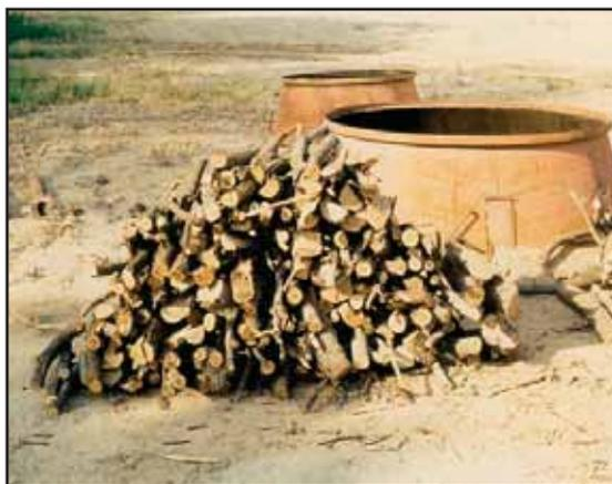
**Figura 7. Horno metálico para fabricación de carbón de leña de mezquite, con una eficiencia de carbonización del 30 por ciento. Un mejor diseño físico de estas estructuras puede incrementar dicha eficiencia (Ortega, 2003; comunicación personal).**
